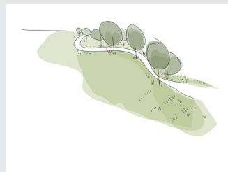
stromořadí v krajině - Kořenová zóna stromu je chráněna pomocí trvalého travního porostu. Voda z komunikace je svedena do zatravněných širokých a mělkých příkopů, odkud se pomalu vsakuje do kořenové zóny stromů.
