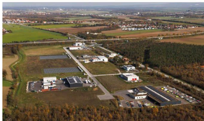
Ekologický průmyslový park malého rozsahu ÖkoWirtschaftspark Föhrenwald v Rakousku s minimalizovaným rozsahem zpevněných ploch, zelenými střechami a začleněním do krajiny.
